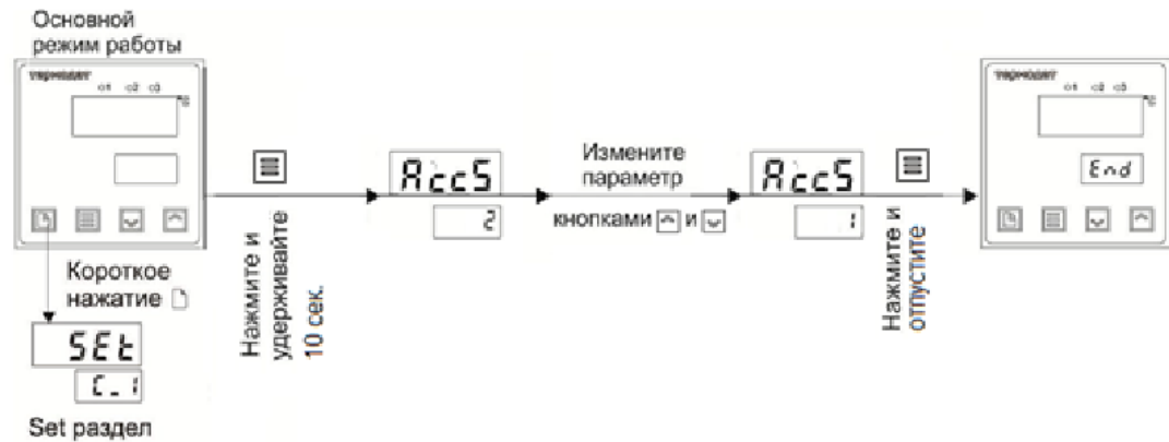
Рис. 6. Схема ограничения случайного изменения сценария работы изделия
